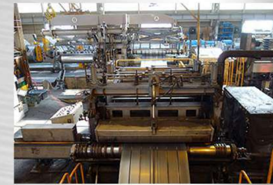
ドライブカットによるスリット方式 テンションユニット(フェルトパッド)の張力 により綺麗な巻き取りに仕上げます。
