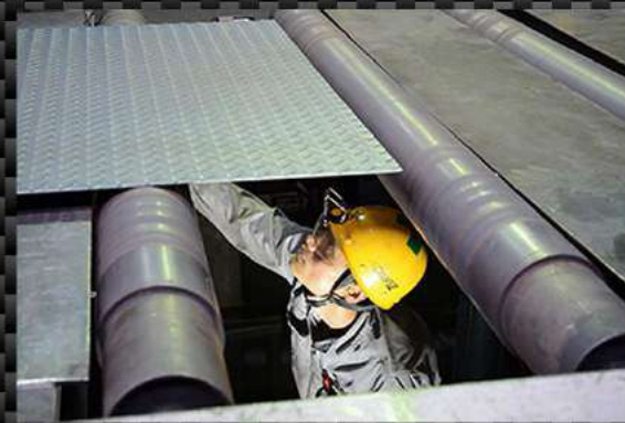
ゲージテーブル上での表面検査、 入り側・出側での裏面検査の実施
