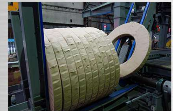
製品荷姿もアイサイド(横向き)・アイアップ(縦向き)に対応、作業効率と安全性が格段にアップしました。
