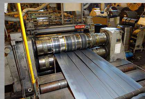
板厚1.6~6.5mm対応のスリッターライン ラインスピードMAX200m/分
