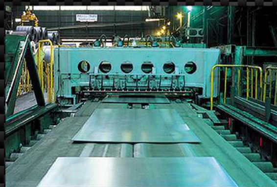
板厚MAX13.0mmのレベラー及びスリット加工が可能な コンビネーションライン
