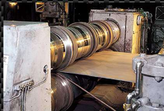
板厚MAX13.0mmのレベラー及びスリット加工が可能な コンビネーションライン
