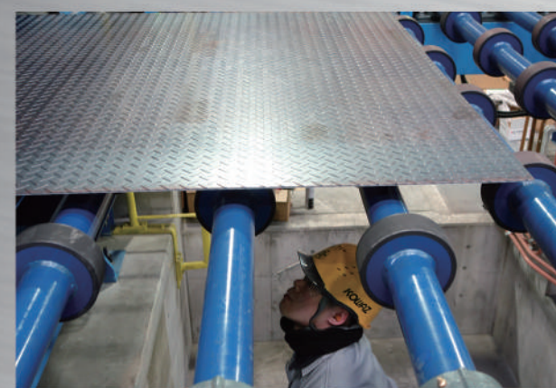
ゲージテーブル上での表面検査、 入側・出側での裏面検査の実施
