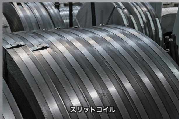
ハイツ材・厚物の多条数取り(50kg 板厚12.7mm最大15条)が可能です。 また、母材・製品ともに最大30tまで加工可能となり、生産性を重視したコイルの大型化にも対応しています。
