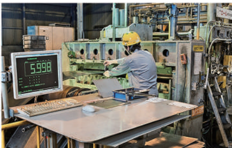
最新のデジタル測定(電子ノギス・電子マイクロ)によるデータの自動取り込み
