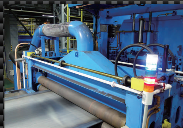
ライト・ヘビーレベラーを挟む形で“№1・ №2スケールブレイカー”を配置しており、 製品表裏面のスケールを除去すると共に、 疵防止にも効果があります。
