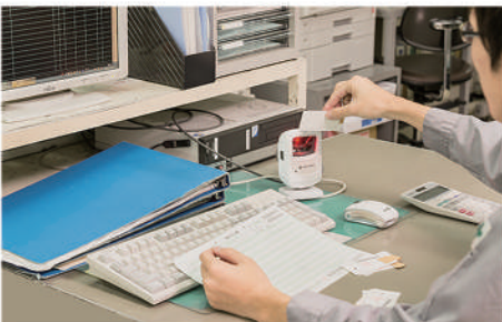
製品ラベル(半券)のバーコードリーダーによる出荷処理!識別管理・誤出荷防止に対応
