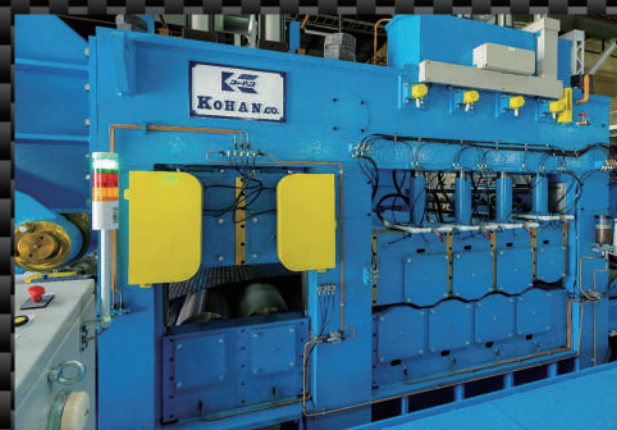
ピンチラフレベラーはレベラーロールに ドクターブレードを装着しており、スケール など異物を除去しながら素材の内部応力を矯 正します。
