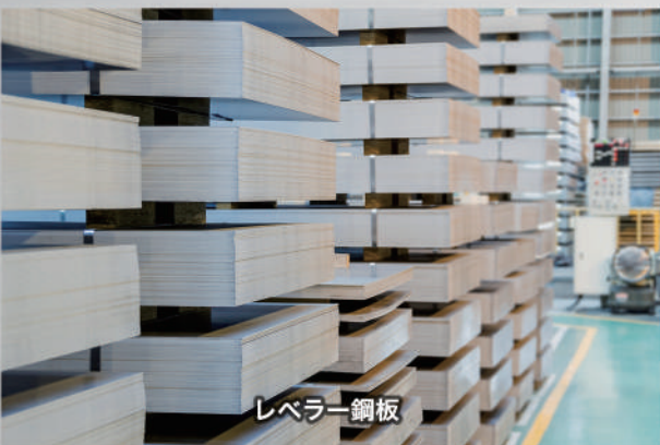
板厚最大 16.0mm、幅最大 2170mm、長さ最大 12000mmまで対応しています。 規格品 (SS400、SM490など) も多種対応可能です。 9.0mm、12.0mmなどの厚物もメーカーと共同で表面スケールの改良を実現しました。
