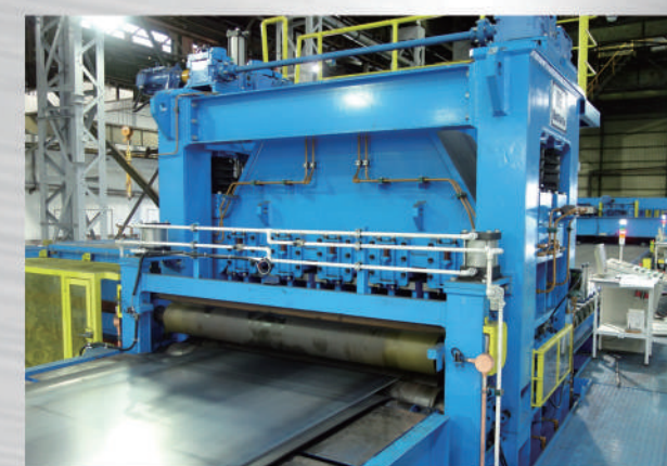
ファイナルレベラーによって、シャーで切断 後の製品について、反り等の平坦の修正・微 調整が可能です。
