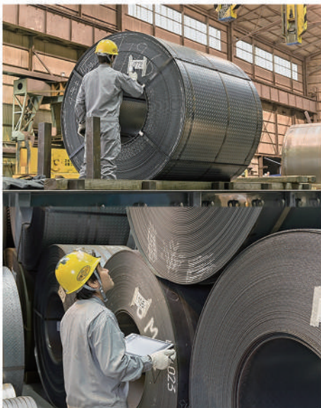
RFID技術を用いた在庫管理システムの導入や、バーコードで製品を管理することでミスのない出荷管理システムを構築しています。
