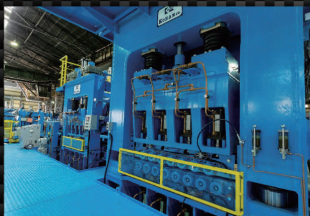
ライトレベラー（板厚1.6mm~6.0mmに対応） ヘビーレベラー（板厚6.0mm~16.0mmに対応） レベラー二基で幅広い板厚に対応可能です。
